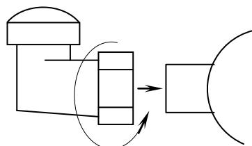
2.1 Совместить входной патрубок сопла с отверстием штуцера водораспределительной системы градирни и завернуть до упора при помощи гаечного ключа как показано на рисунке.
